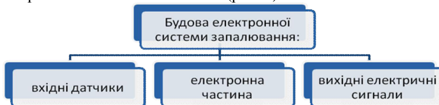
Рис. 1. Будова електронної системи запалювання
